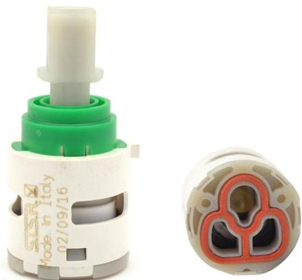
Cartuccia di tipo chiuso, con tacca di posizionamento sul corpo del rubinetto. Angolo di apertura della leva 25° (12,5° + 12,5°). Rotazione della leva in miscelazione 100°. Temperatura di utilizzo da 5° C a 70°C. Altezza totale 53 mm. Asta quadro 9x9 mm.
