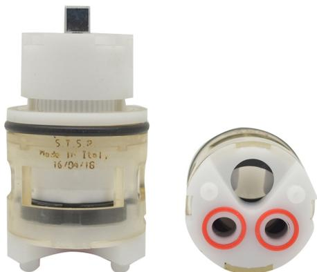
Cartuccia di tipo aperto, angolo apertura della leva 24° (11,5°-12,5°). Rotazione leva in miscelazione 110°. Sistema antirumore. Sistema idraulico per compressione dei dischi ceramici. Asta di comando con quadro 7x7mm. Temp. utilizzo da 5°C a 70°C. Altezza totale 70 mm.
