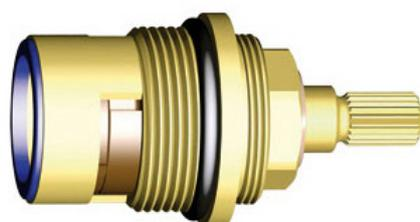
Rotazione 90°, realizzato con lega di ottone a basso tenore di piombo con trattamento di normalizzazione. Valore di compressione dei dischi indipendente dalla coppia di serraggio. Temperatura di utilizzo da 5° C a 70° C.
