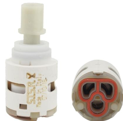
Cartuccia di tipo aperto, con pioli di posizionamento sul fondo del rubinetto. Angolo di apertura della leva 25° (12,5° + 12,5°). Rotazione della leva in miscelazione 100°. Temperatura di utilizzo da 5° C a 70°C. Altezza totale 55 mm. Quadro 9 x 9 mm.
