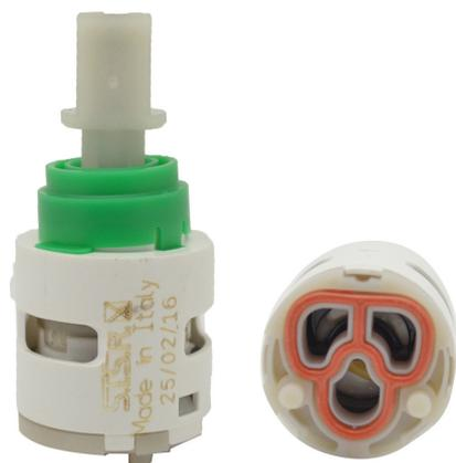
Cartuccia di tipo chiuso, con pioli di posizionamento sul fondo del rubinetto. Angolo di apertura della leva 25° (12,5° + 12,5°). Rotazione della leva in miscelazione 100°. Temperatura di utilizzo da 5° C a 70°C. Altezza totale 55 mm. Asta quadro 9x9 mm.
