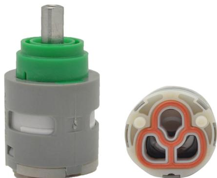
Deviatore a 2 vie di tipo chiuso. Fondo piatto. Rotazione della leva 180° (comprensivi della chiusura del flusso). Temperatura di utilizzo da 5° C a 70°C. Altezza totale 45 mm. Asta 6x5 mm.
